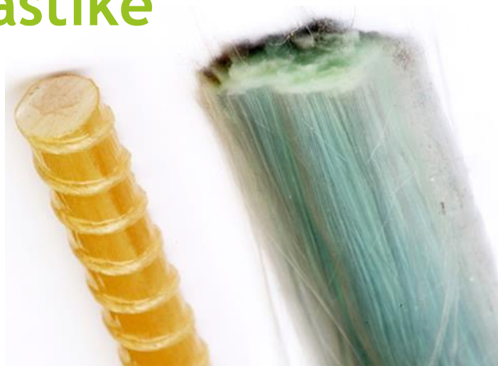
Slika 4: Stekloplastični izdelek pred (levo) in po odžigu (desno).
